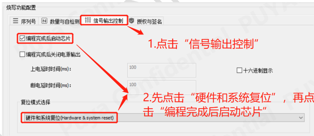
图 3-4 创芯工坊操作勾选“编程后重启芯片”
