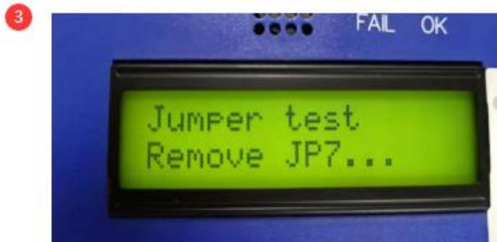
③ 移除 JP7 短接线后, 显示 Insert JP1, 此时请将 JP1 部分短接, 短接后按照提示按下按键 以及移除 JP1 短接线, 如图:
